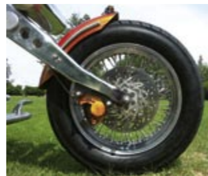
Man sieht deutlich die große Anzahl von Speichen, die wegen der Doppelscheiben notwendig wurde.
