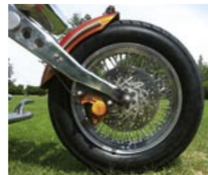
Man sieht deutlich die große Anzahl von Speichen, die wegen der Doppelscheiben notwendig wurde.
