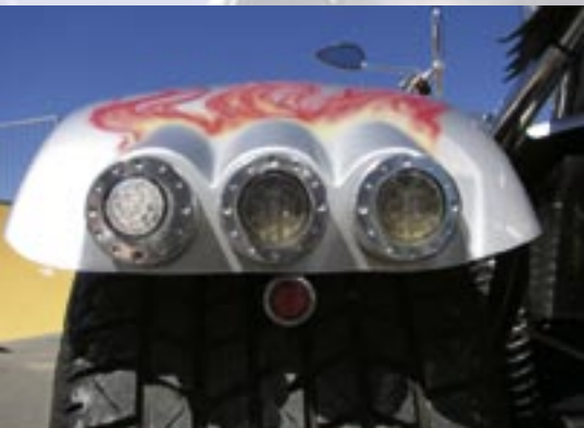
Die neuen Ruckleuchten in LED-Optik am modifizierten Kotflugel mit leicht abgerundeten Ecken.
