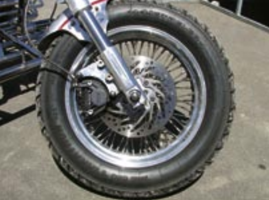
Nicht grade alltaglich, Doppelscheibenbremsen in einem Speichenrad und ein Hauch von Kotflugel.
